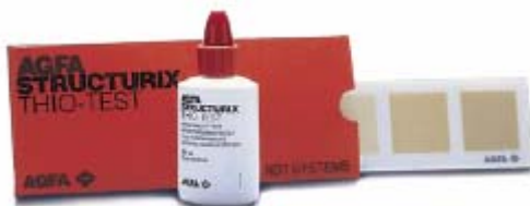
Obr. 7 - Thio-test – chemický roztok a mierka pre určenie archivačnej doby filmu
