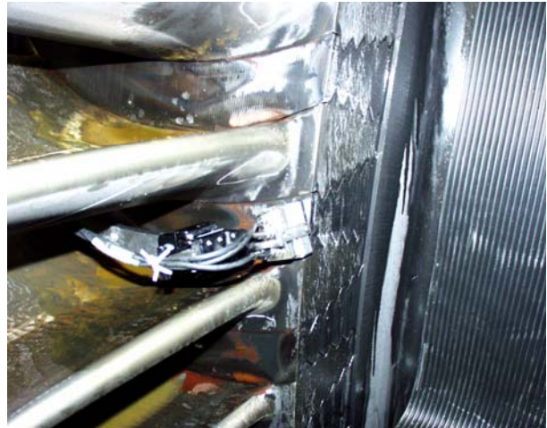
Obr. 9 – príklad merania na zámku lopatky turbíny v polohe 2
